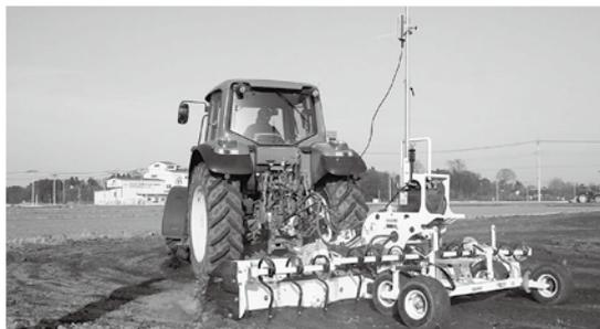
レーザーシステムにより平らな圃場にするレーザーレベラー
