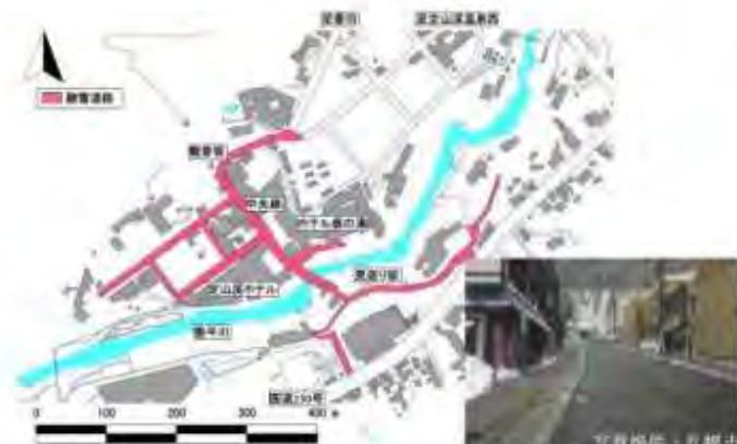
札幌市の定山渓温泉では、昭和41年に2400万円の施設整備費を投じて、温泉水を用いたロードヒーティングを採用しています。降雪期間中は温泉水を24時間連続供給しています。温泉水は温泉井戸から取水しロードヒーティングで利用した後、井戸に還元しています。電気式のロードヒーティングに比べ電気利用量が9割削減出来ています。
